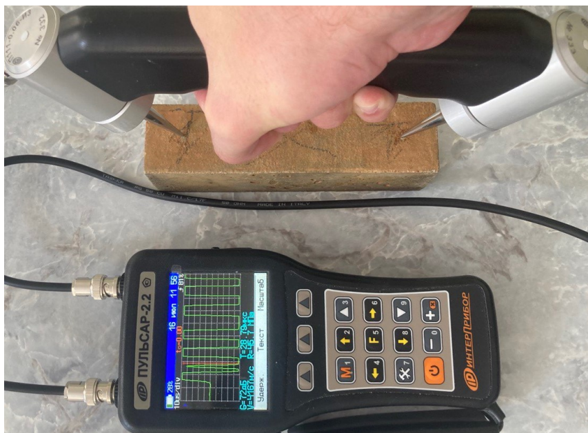
Рис. 4. Ультразвуковая диагностика образца мелкозернистого бетона через 12 мес твердения в воде при 80 °С
