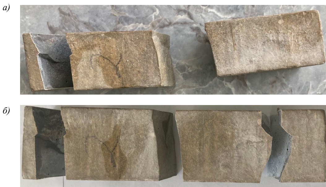
Рис. 3. Разрушение образца 4×4×16 см на пылевидном кварце через 17,5 мес (а) и 18 мес (б) твердения в воде при 80 °С
